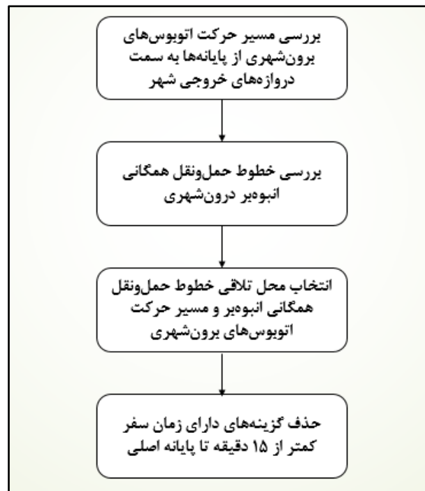
شکل ۱-۵- الگوریتم مورد استفاده جهت مکان‌یابی پایانه‌های برون‌شهری غیرمتمرکز
