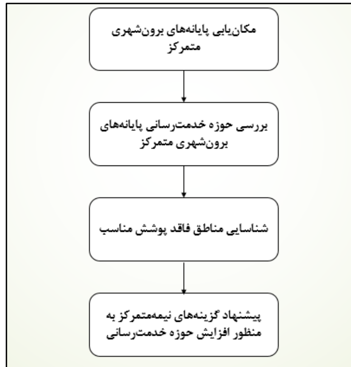
شکل ۳-۱- الگوریتم مورد استفاده جهت مکان‌یابی پایانه‌های برون‌شهری نیمه‌متمرکز
