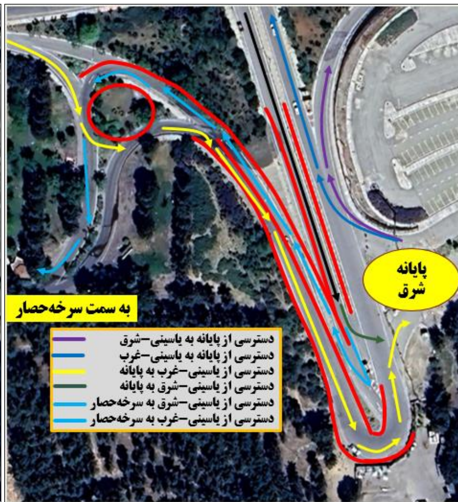
شکل ۷-۱۳- سناریو شماره سه محدوده غربی پایانه. ایجاد میدان جدید و تفکیک حرکات موجود
