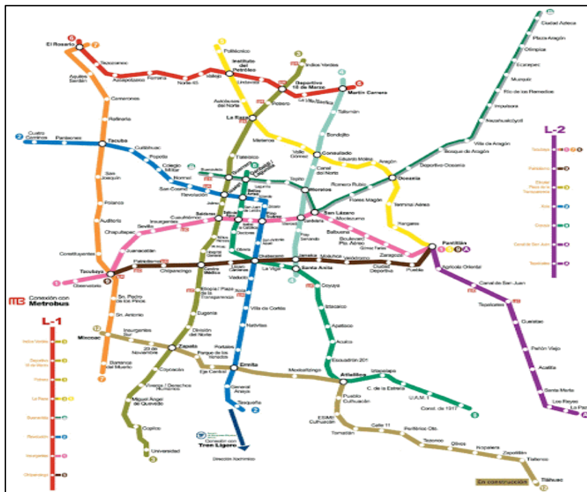
شکل ۴-۱: ساختار شطرنجی شبکه مترو (مکزیکوسیتی)
