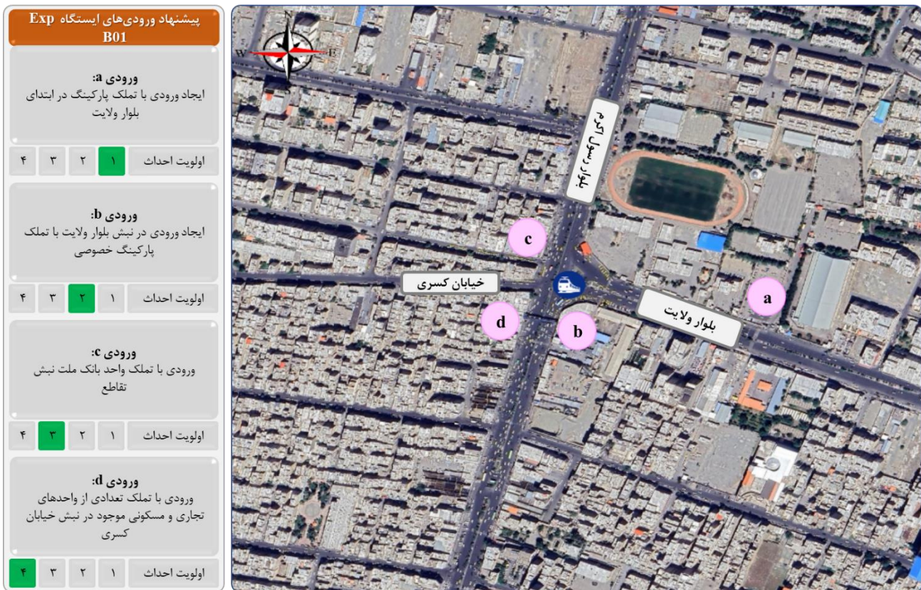
شکل ۳-۵: پلان هوایی ورودی‌های پیشنهادی ایستگاه EXP B ۰۱
