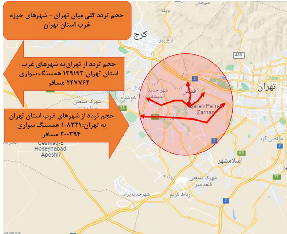
شکل ۱۲-۱: حجم کل همسنگ سواری و برآورد مسافران مجموعه شهرهای غرب استان تهران-تهران بر اساس اطلاعات برداشت شده
