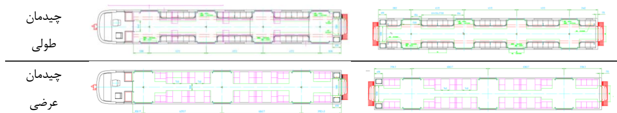
شکل ۱-۶- نمایش چیدمان عرضی و طولی قطارهای مترویی استفاده شده در کشور
