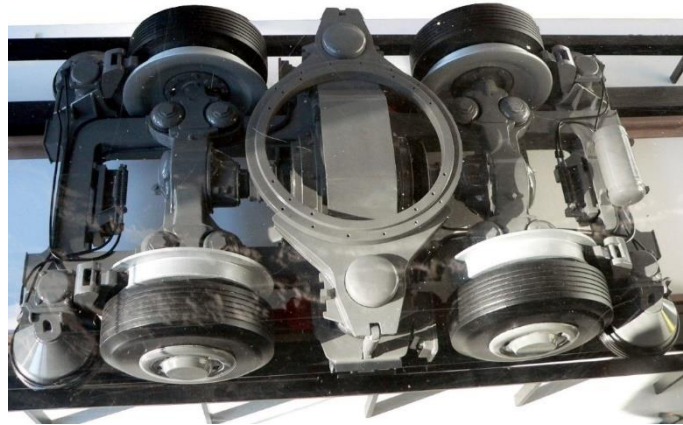
شکل ۱۴-۵- نمای یک بوژی مترو با چرخ های لاستیکی
