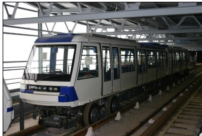
شکل ۱۱-۵- مترو Lausanne (قطار با چرخ‌های لاستیکی و بدون راهبر)
