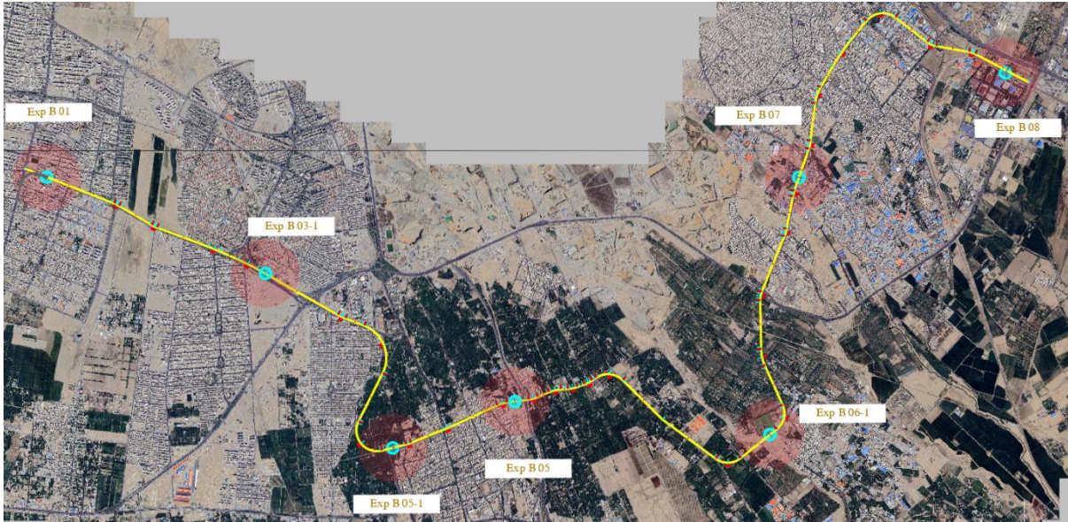
شکل ۱۳-۴: پلان مسیر و جانمایی ایستگاه‌های گزینه هفتم
