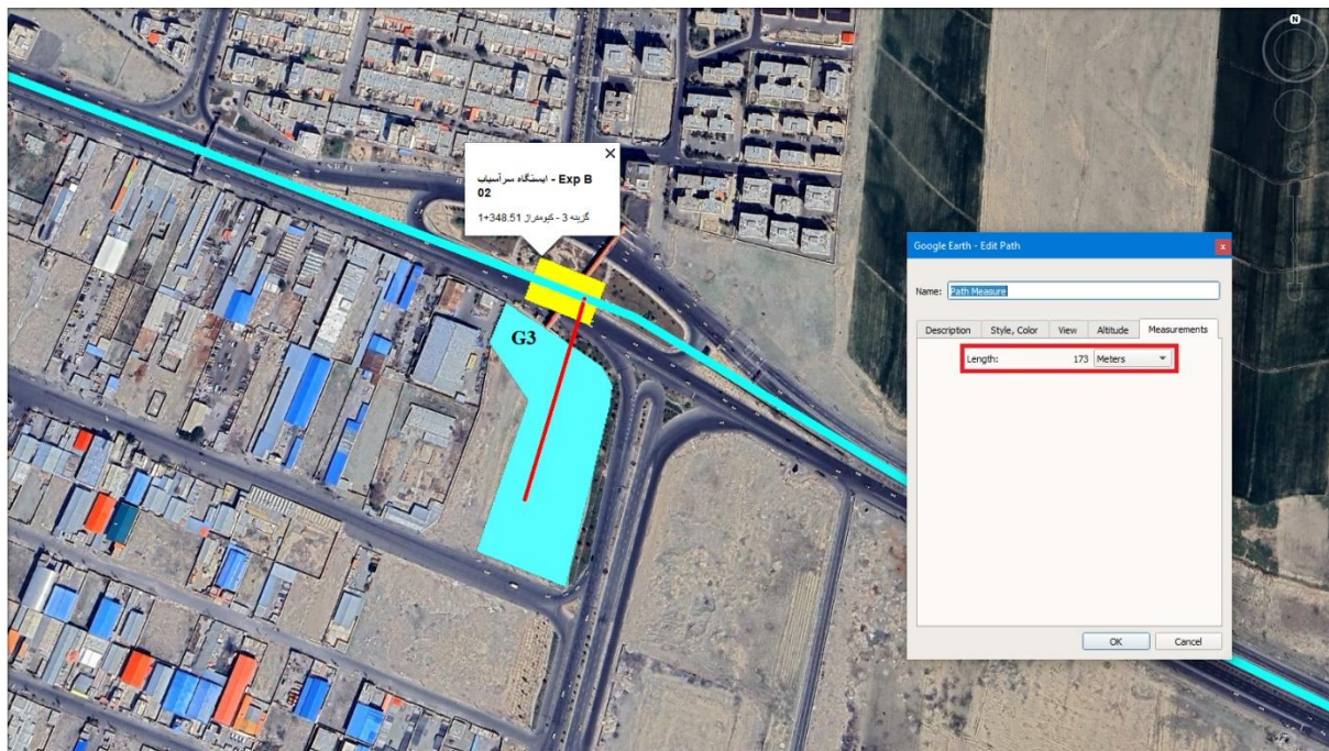
شکل ۱۲۳-۴: ریمپ دسترسی در سایت G3 با طول حدود ۱۷۳ متر و شیب ۱۵ درصد - ایستگاه سرآسیاب (Exp B 02)
