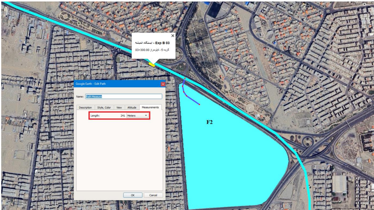
شکل ۱۶۶-۴: رمپ دسترسی در سایت F2 با طول ۲۴۱ متر و شیب ۱۱ درصد – ایستگاه اندیشه (Exp B 03)
