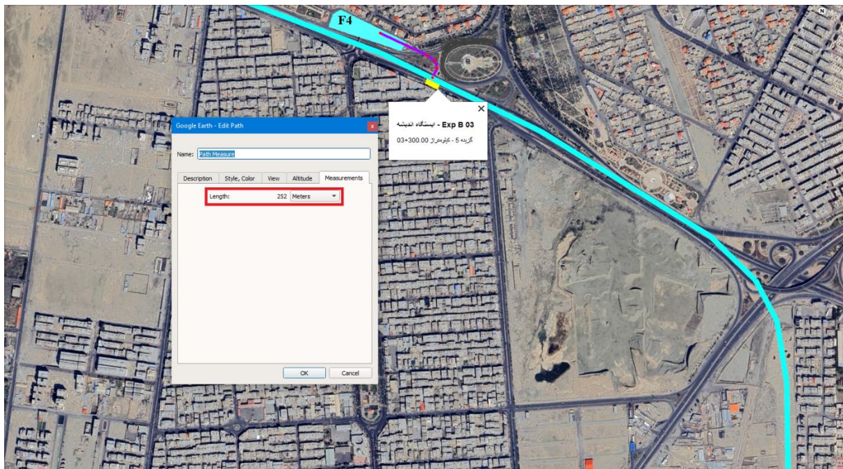
شکل ۱۶۸-۴: رمپ دسترسی در سایت F4 با طول ۲۵۲ متر و شیب ۱۰ درصد - ایستگاه اندیشه (Exp B 03)
