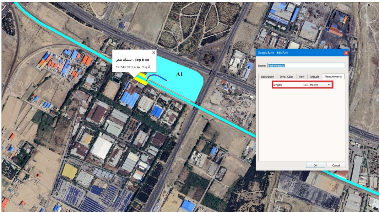
شکل ۷۳-۴: ریمپ دسترسی در سایت A1 با طول حدود ۱۷۳ متر و شیب ۱۵ درصد - ایستگاه ملکی (Exp B 08)
