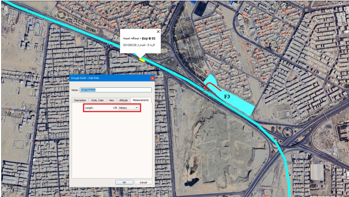
شکل ۱۶۷-۴: رمپ دسترسی در سایت F3 با طول ۱۷۸ متر و شیب ۱۵ درصد - ایستگاه اندیشه (Exp B 03)
