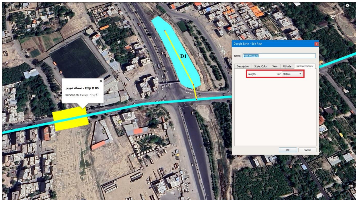
شکل ۴-۴۴: رمپ دسترسی در سایت D1 با طول حدود ۱۷۷ متر و شیب ۱۵ درصد - ایستگاه شهریار (Exp B 05)
