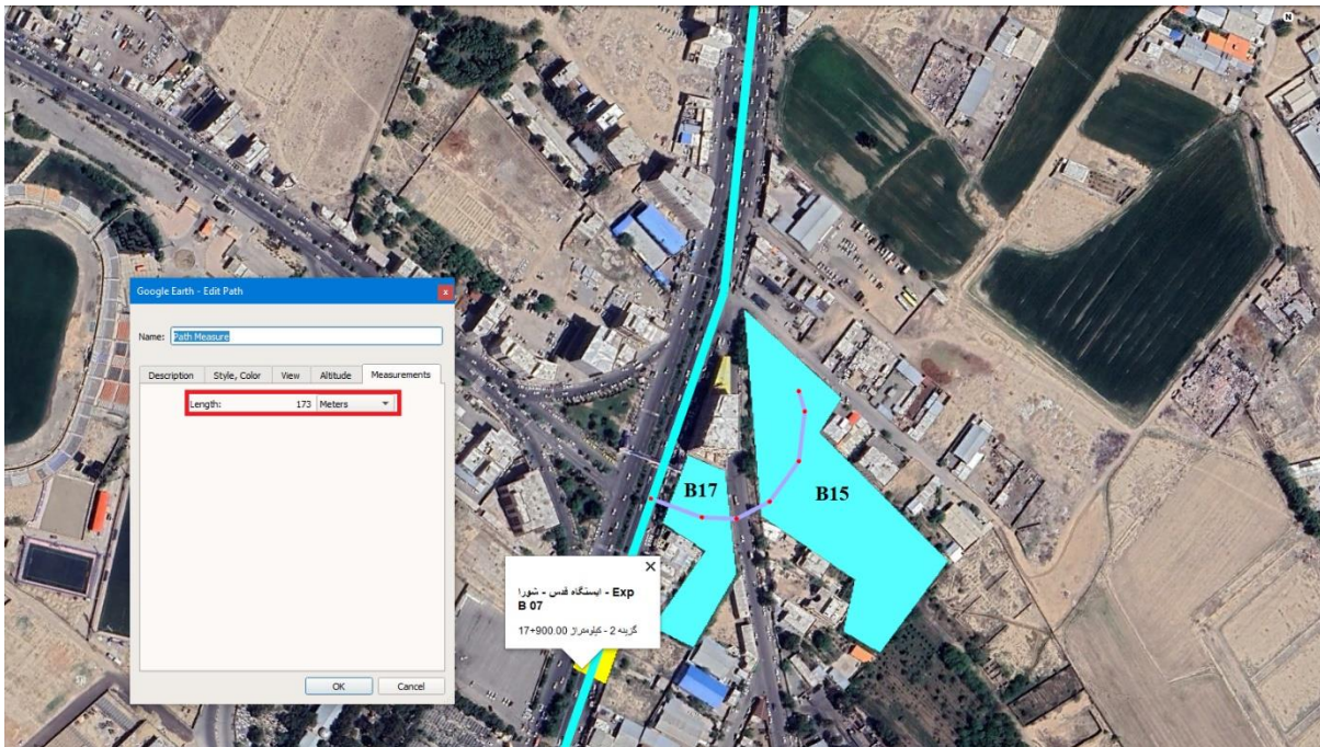
شکل ۱۱۴-۴: رمپ دسترسی در سایت B17 و B15 با طول حدود ۱۷۳ متر و شیب ۱۵ درصد - ایستگاه قدس - شورا (Exp B 07)
