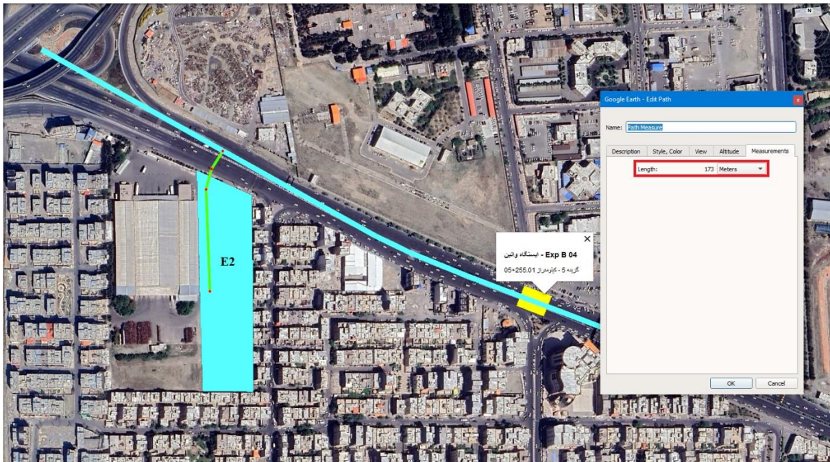
شکل ۱۷۸-۴: رمپ دسترسی در سایت E2 با طول ۱۷۳ متر و شیب ۱۵ درصد – ایستگاه واٹین (Exp B 04)
