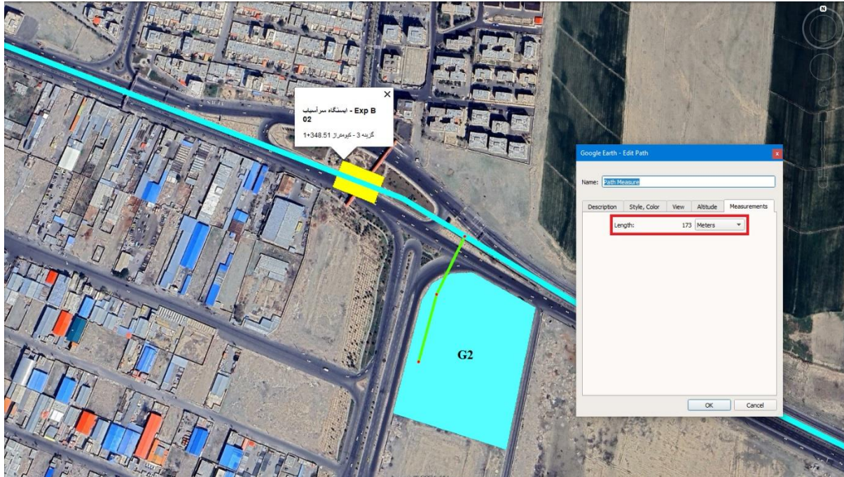
شکل ۱۲۲-۴: ریمپ دسترسی در سایت G2 با طول حدود ۱۷۳ متر و شیب ۱۵ درصد - ایستگاه سرآسیاب (Exp B 02)
