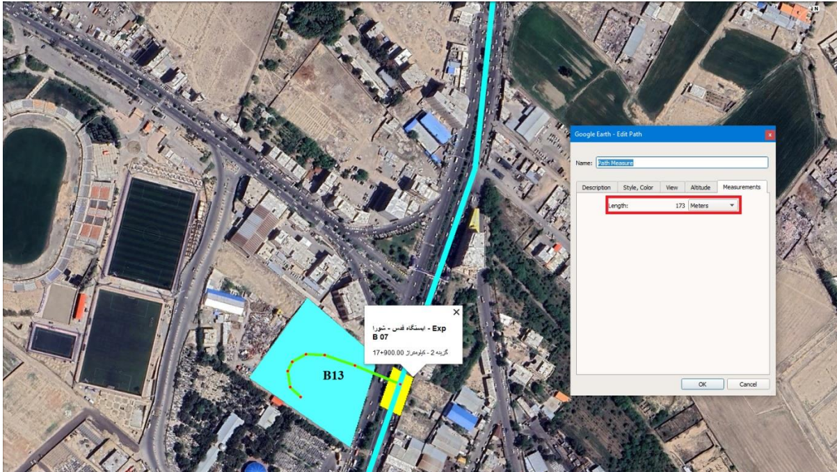
شکل ۱۰۸-۴: ریمپ دسترسی در سایت B13 با طول حدود ۱۷۳ متر و شیب ۱۵ درصد - ایستگاه قدس - شورا (Exp B 07)
