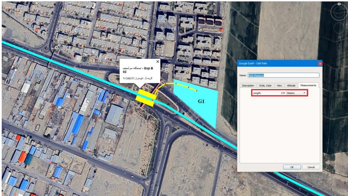
شکل ۱۲۱-۴: رمپ دسترسی در سایت G1 با طول حدود ۱۷۳ متر و شیب ۱۵ درصد - ایستگاه سرآسیاب (Exp B 02)
