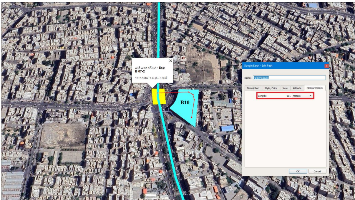
شکل ۱۳۲-۴: رمپ دسترسی در سایت B10 با طول حدود ۱۶۱ متر و شیب ۱۶ درصد - ایستگاه میدان قدس (Exp B 07-2)
