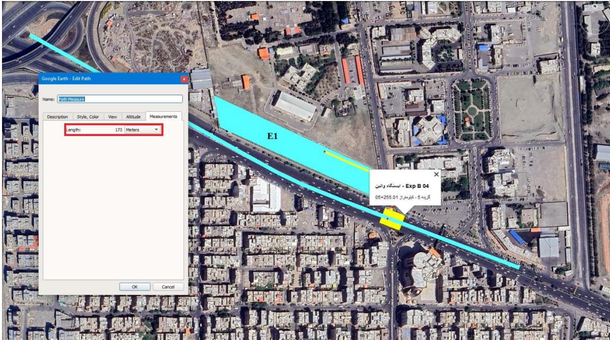
شکل ۱۷۷-۴: رمپ دسترسی در سایت E1 با طول ۱۷۳ متر و شیب ۱۵ درصد – ایستگاه واٹین (Exp B 04)
