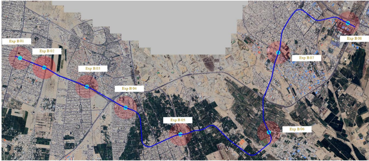
شکل ۱۵-۴: پلان مسیر و جانمایی ایستگاه‌های گزینه مصوب
