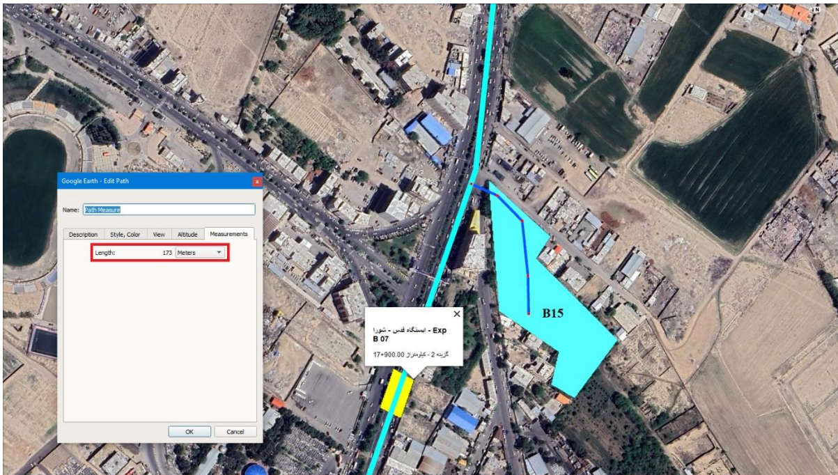
شکل ۴-۱۱۰: رمپ دسترسی در سایت B15 با طول حدود ۱۷۳ متر و شیب ۱۵ درصد - ایستگاه قدس - شورا (Exp B 07)
