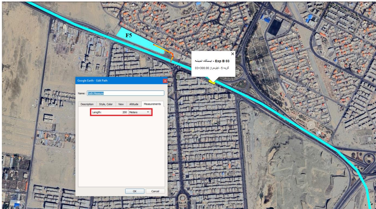
شکل ۱۶۹-۴: رمپ دسترسی در سایت F5 با طول ۲۰۰ متر و شیب ۱۳ درصد - ایستگاه اندیشه (Exp B 03)
