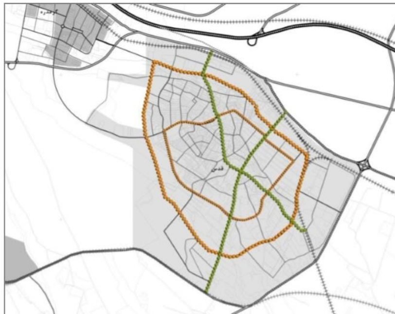
نقشه شماره 25-211: ساختار شعاعی، حلقوی پیشنهادی طرح جامع برای شبکه ارتباطی شهر قدس
