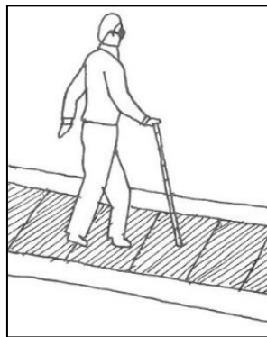
شکل شماره 7-26: کفسازی شاخص مسیر حرکت نابینایان
